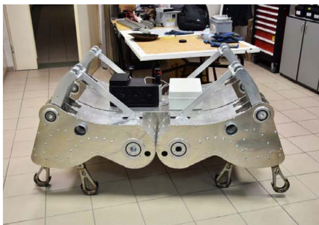
↑Krab – autonomiczny robot krocący rozwijany przez studentów i pracowników Wydziału Mechaniki Politechniki Wrocławskiej.
